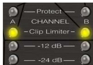
**¡ Evítese mantener este LED continuamente encendido !.** No se obtiene mayor potencia y se pierde dinámica y calidad musical.
